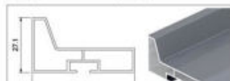
型号 FWL009 名称 拉手 厚度 1.0mm 重量 0.463kg/m
