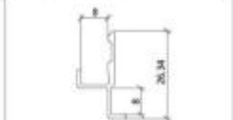
型号 FW-2002 名称 快装 Model Name Quick loading 壁厚 1.0mm 重量 0.147kg/m Thickness Weight
