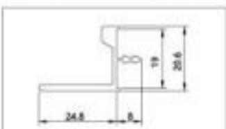
型号 AS-0212 名称 厚度 2.0mm 重量 0.284kg/m
