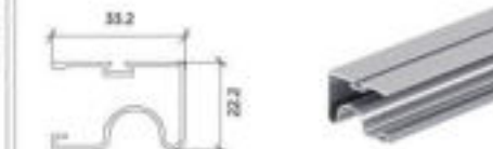
型号 Model HQ-1185 名称 Name 壁厚 Thickness 1.0mm 重量 Weight 0.316kg/m
