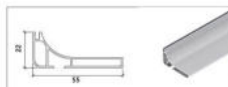
型号 SA-0368 名称 拉手 厚度 1.1mm 重量 0.44kg/m
