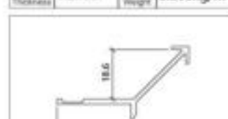
型号 FW-8519 名称 Model Name 壁厚 1.2mm 重量 0.312kg/m Thickness Weight
